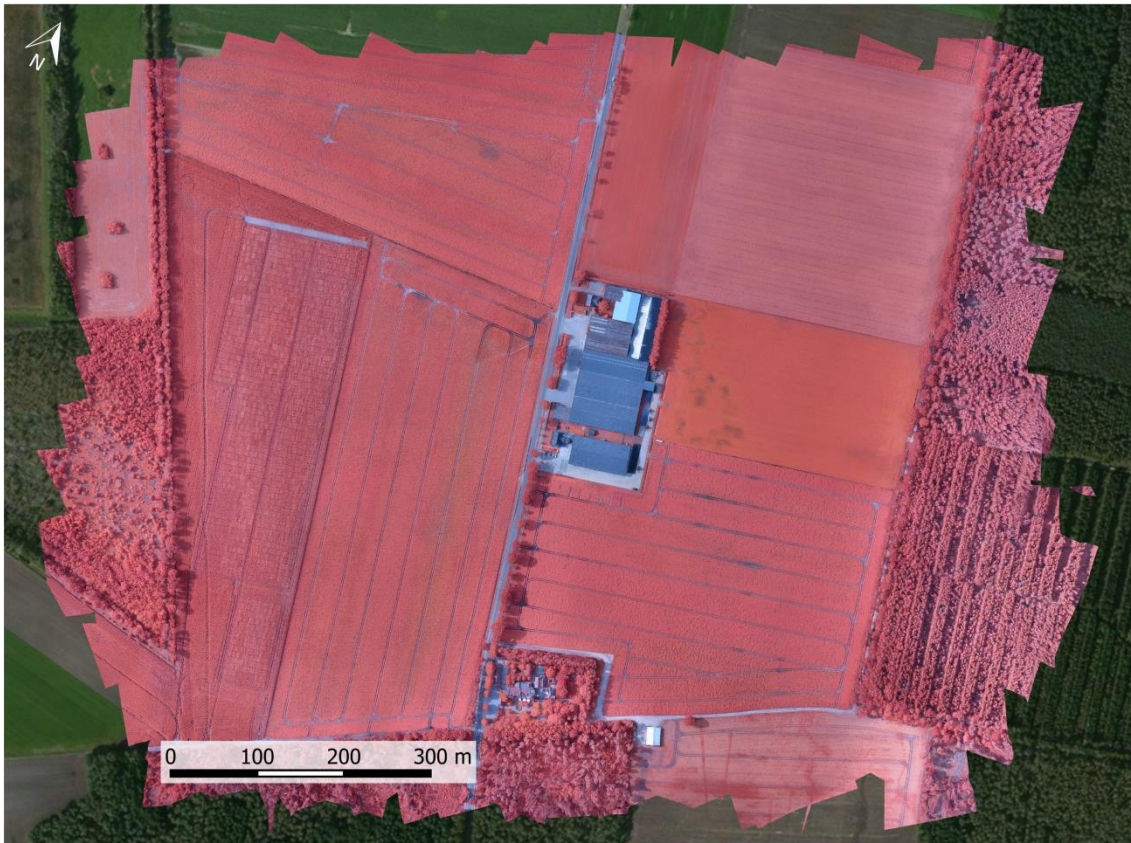
Figuur 24. Het orthomozaïek: geometrisch gecorrigeerde en samengevoegde nabij-infrarood beelden met georeferentie en een resolutie van 5 cm per pixel (5 aug 2015).
