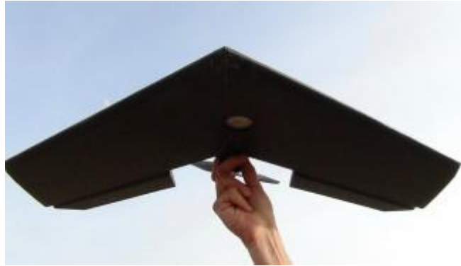
Figuur 20. De Flying Sensor 'Pelican', die gebruikt werd voor de studie, bevat een nabij-infrarood sensor (HiView, 2015).
