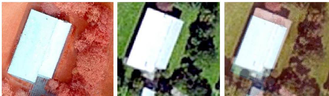
Figuur 58. Links een uitsnede uit de orthomozaïek, in het midden een uitsnede van de corresponderende locatie uit de referentiekaart, rechts de overlay van de twee voorgaande uitsneden, waarop een verschuiving van het object in zuidwestelijke richting te zien is.
