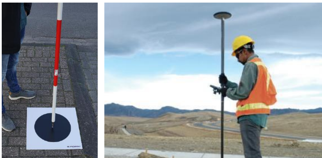
Figuur 7. Voorbeelden van het inmeten van een grondreferentiepunt met dGPS.
