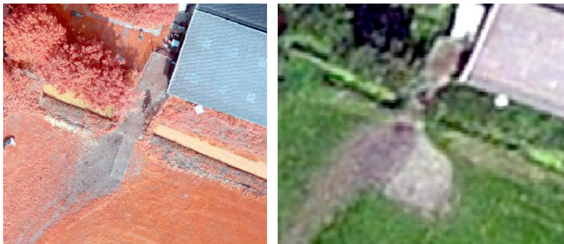
Figuur 55. Links een uitsnede uit de orthomosaïek waarop het einde van het betonnen pad in het weiland duidelijk zichtbaar is. Rechts een uitsnede uit de referentiekaart, waarop het corresponderende punt niet zichtbaar is.
