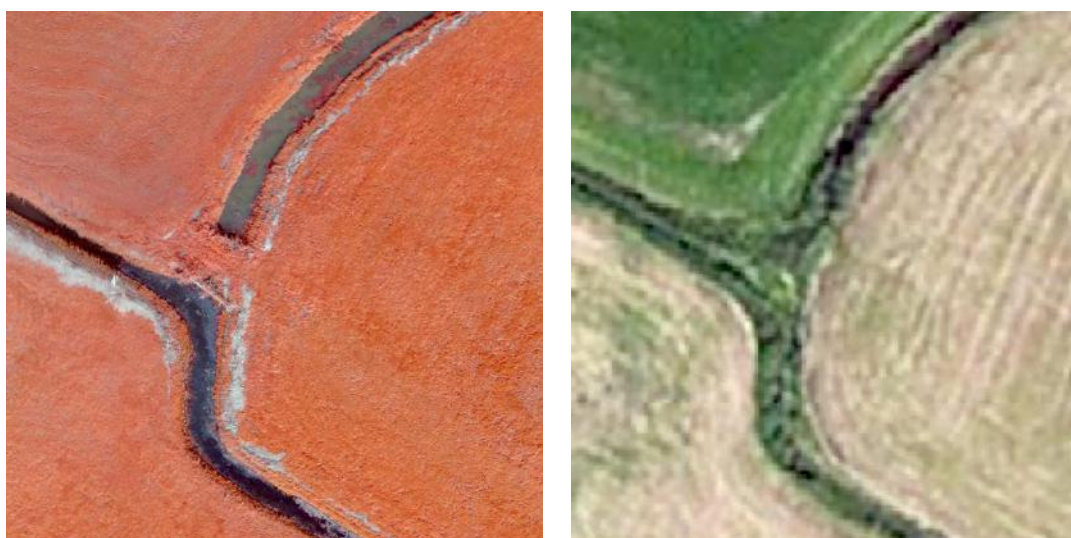
Figuur 56. Links een uitsnede uit de orthomosaïek waarop het dammetje en de scheiding tussen land en water duidelijk zichtbaar zijn. Rechts een uitsnede uit de referentiekaart, waarop het corresponderende punt niet duidelijk zichtbaar is.
