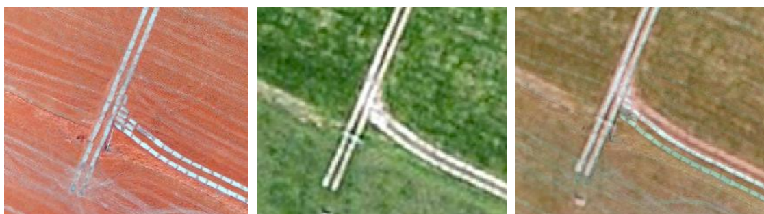
Figuur 57. Links een uitsnede uit de orthomosaïek, in het midden een uitsnede van de corresponderende locatie uit de referentiekaart, rechts de overlay van de twee voorgaande uitsneden, waarop een verschuiving van het object in zuidelijke richting te zien is.
