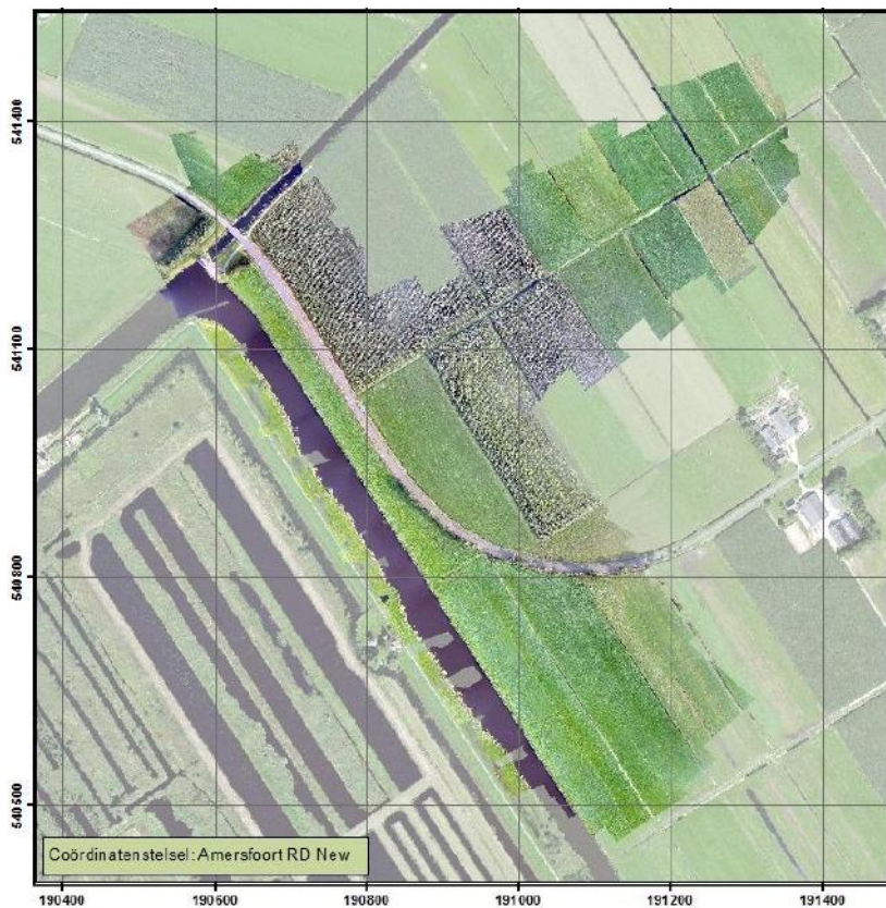
Figuur 8. Gemozaïekt beeld van het pilotgebied bij Oldelamer. In totaal zijn voor het verkrijgen van deze orthomosaïek 108 RGB luchtfoto's genomen op 16 september 2014.
