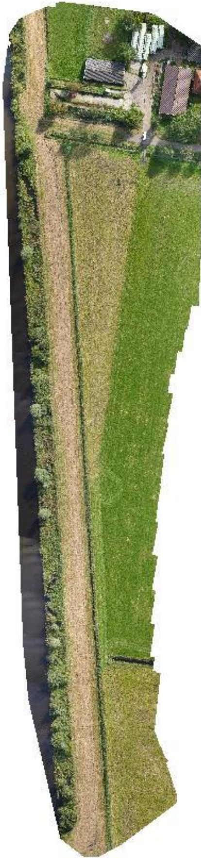
Figuur 72. RGB orthomozaïek van het pilotgebied bij Haskerdijken. Voor deze orthomozaïek zijn op 2 oktober 2015 luchtfoto's gemaakt vanuit een multicopter (bron: Droneview).
